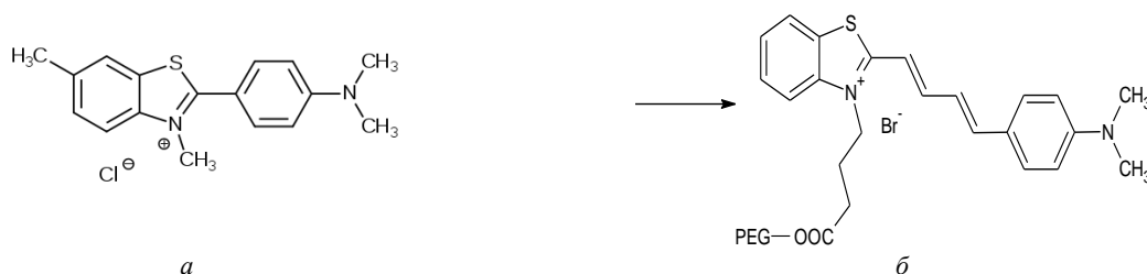
Рисунок 1 – Структурная схема тиофлавина Т (а) и дикарбоцианинового красителя, модифицированного полиэтиленгликолем (Th-C8, б).
