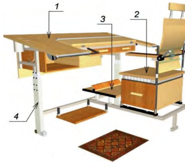
Рис. 4. Загальний ізометричний вид індивідуальної конторки-парти для роботи стоячи й сидючи «ПОЛІЛАР»
