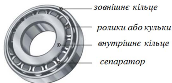
Рис.2.69. Загальний вигляд вальниці кочення.
