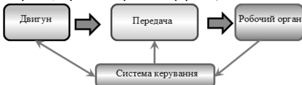
Рис. 1. Структурна схема машини
