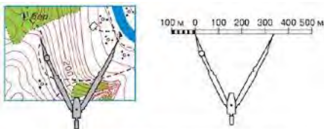
Мал. 27. Вимірювання відстані за допомогою лінійного масштабу
