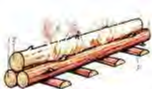
Нодья: 1 – нижня бревно, 2 – верхня бревно (основная), 3 – поперечина (используется при глубоком снежном покрове или на сухой даче)
