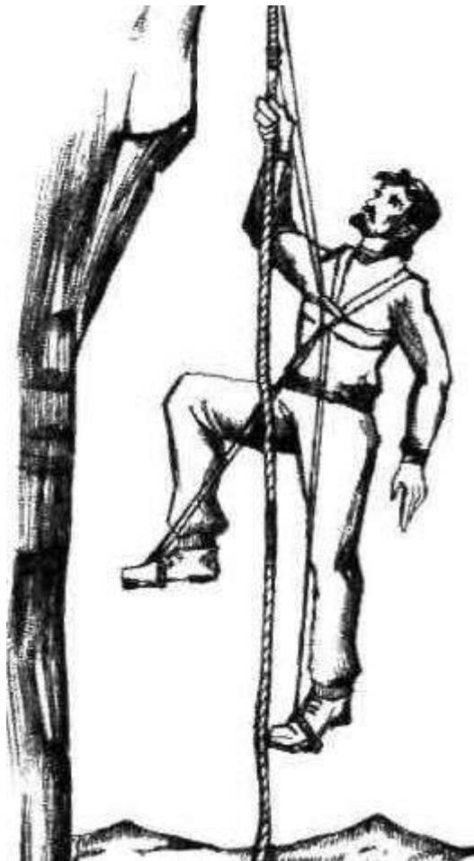
Рис. 6.2.4. Підйом на стременах за допомогою захоплювальних вузлів
