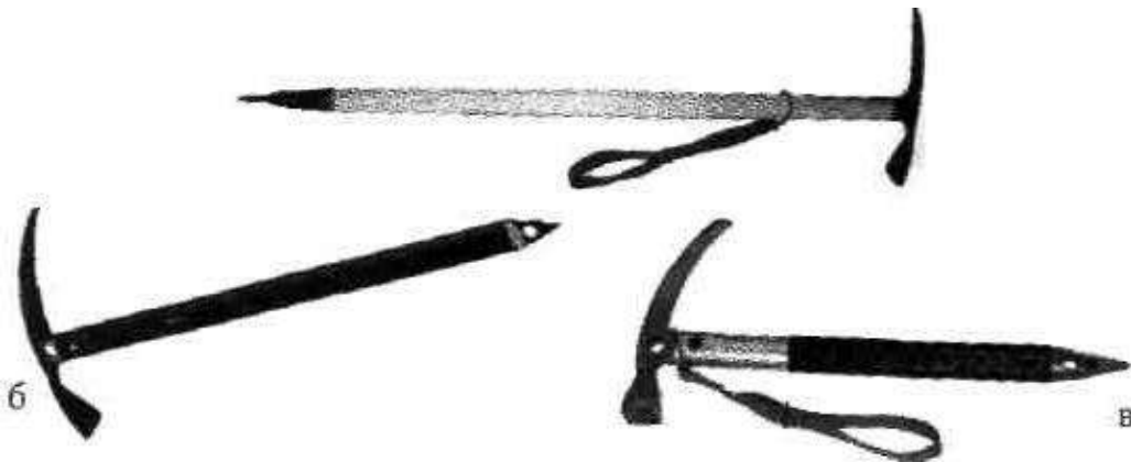
Рис. 5.7.6. Льодоруби: а - з дерев'яним древком; б - металевий, в - айсбайль
